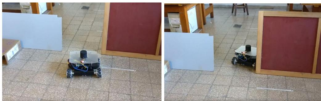
Figura 9.3.2: Robot navegando a través de la abertura de ancho variable
