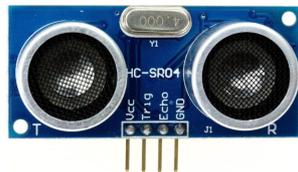
Figura 3.4.16: Sensor de Ultrasonido
