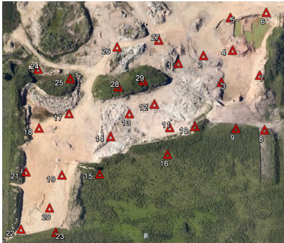
Figura 77 – Puntos utilizados como puntos de apoyo (en rojo) para el procesamiento con 29 puntos de apoyo
