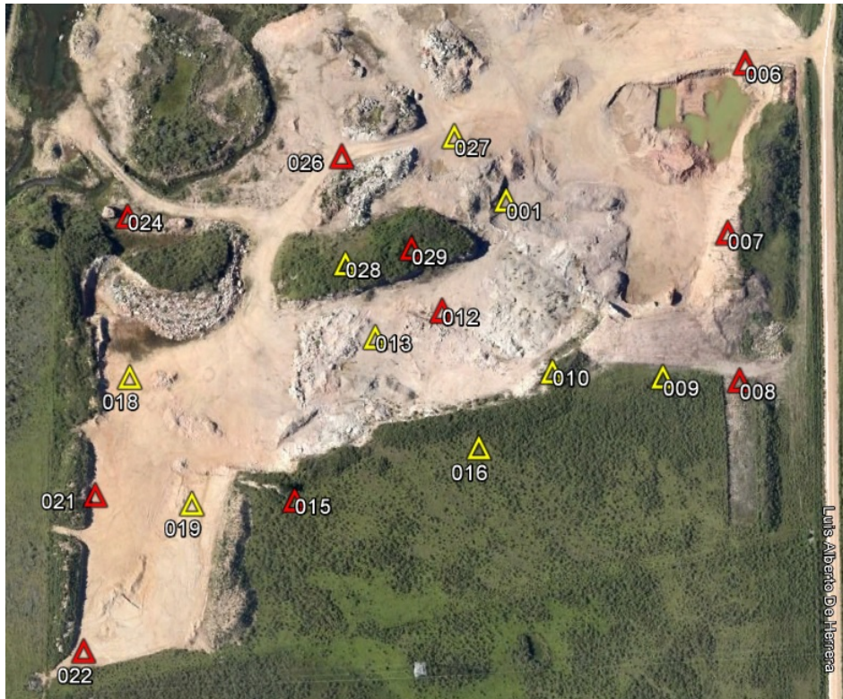
Figura 63 – Puntos utilizados como puntos de apoyo (en rojo) y de control de calidad (en amarillo) para el procesamiento con 10 puntos de apoyo
