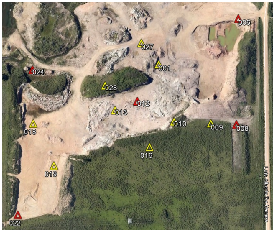
Figura 70 – Puntos utilizados como puntos de apoyo (en rojo) y de control de calidad (en amarillo) para el procesamiento con 5 puntos de apoyo
