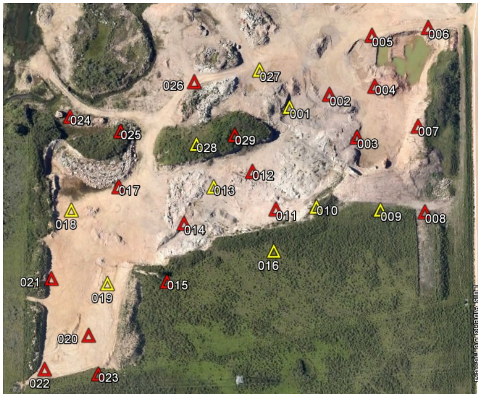
Figura 56 – Puntos utilizados como puntos de apoyo (en rojo) y de control de calidad (en amarillo) para el procesamiento con 20 puntos de apoyo
