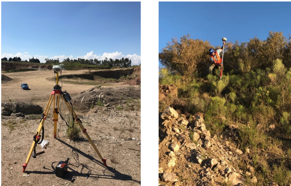
Figura 30 – Base colocada y relevamiento con GNSS
