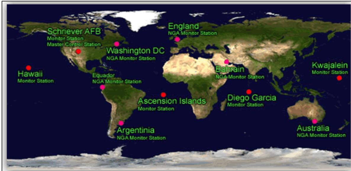
Imagen 172- Estaciones en tierra del sistema GPS.<sup>95</sup>
