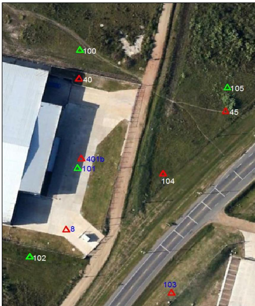
Imagen 45- Puntos de control planificados (en verde) y sustituidos (en rojo) para la aerotriangulación.<sup>37</sup>
