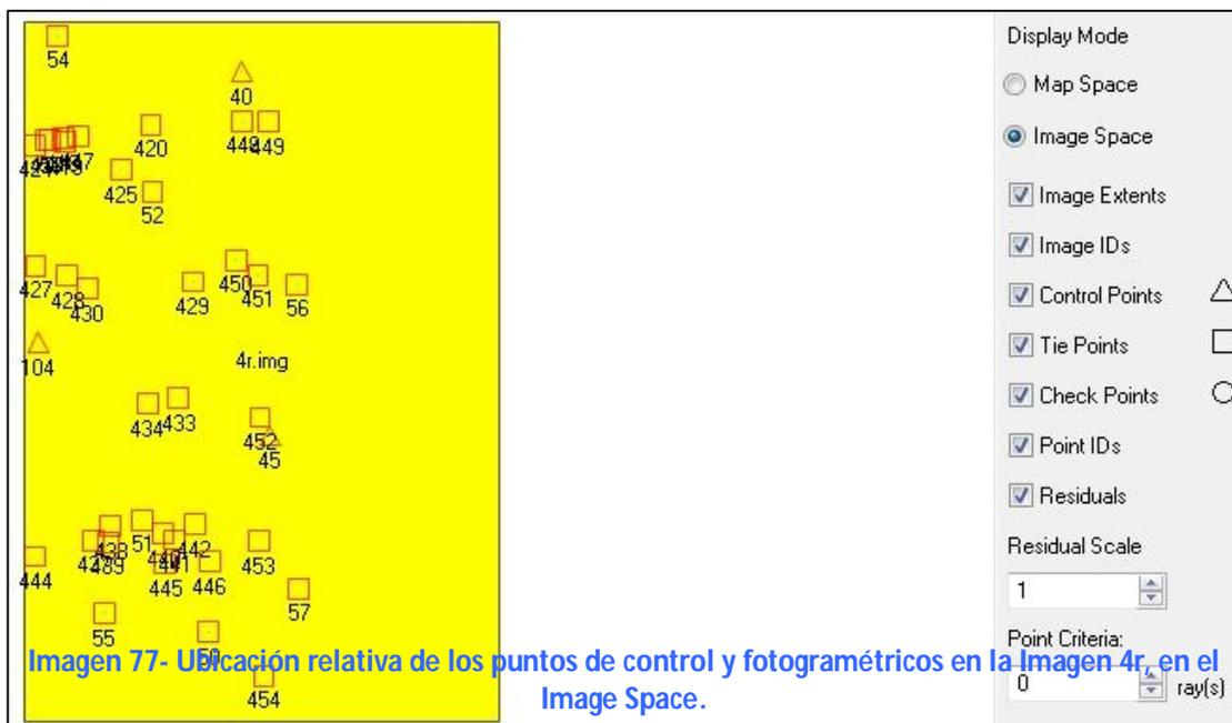
Imagen 77- Ubicación relativa de los puntos de control y fotogramétricos en la Imagen 4r, en el Image Space.
