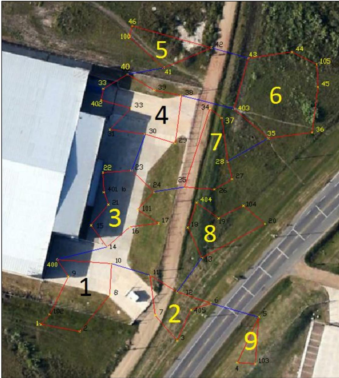
Imagen 13-Circuitos de nivelación y puntos de paso.<sup>24</sup>
