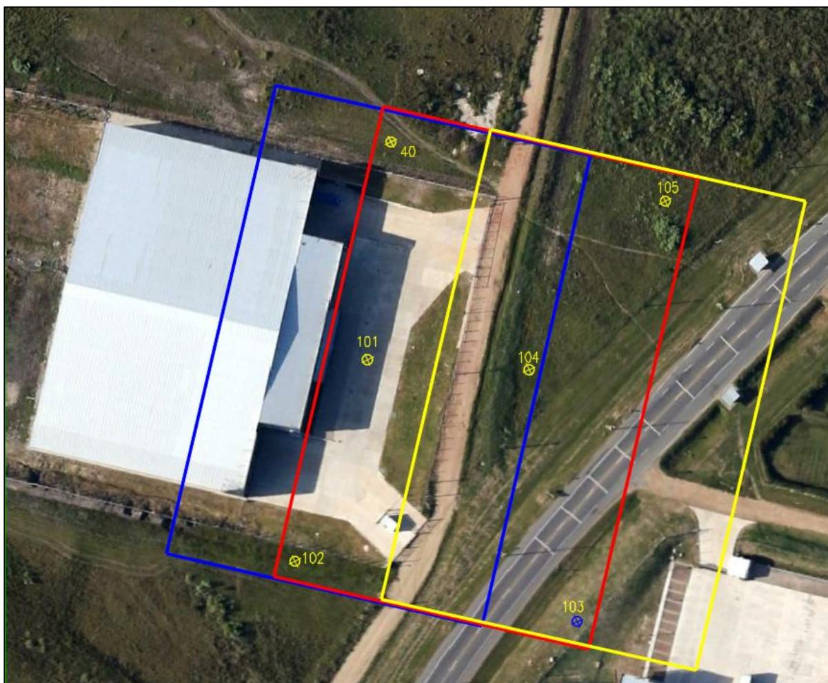
**Imagen 15- Ubicación de los puntos de control referidos a las huellas planificadas inicialmente para el vuelo a 100 m de altura.<sup>26</sup>**
