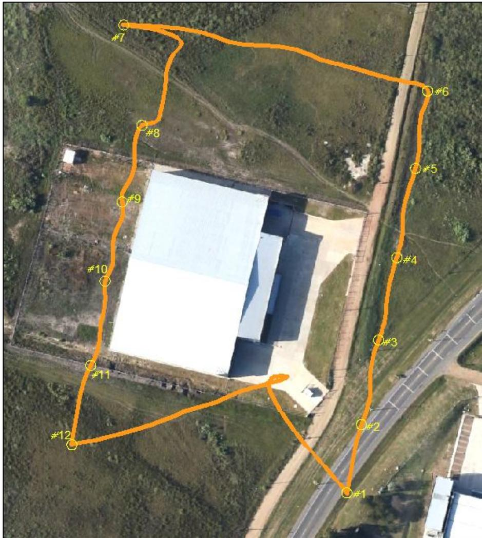
Imagen 14- Recorrido efectuado por el dron y puntos de toma de las imágenes.<sup>25</sup>
