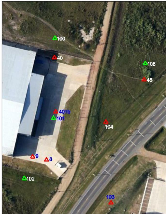
Imagen 75- Puntos de control utilizados en la aerotriangulación (en rojo) con el punto 9 agregado.<sup>38</sup>
