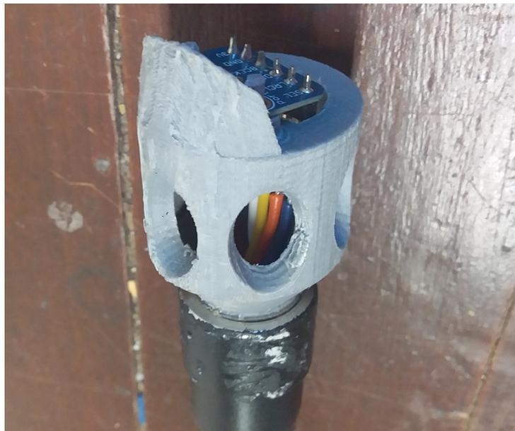
Figura 4.6: Pieza impresa para soportar el micrófono y enroscar con el *gooseneck*.
