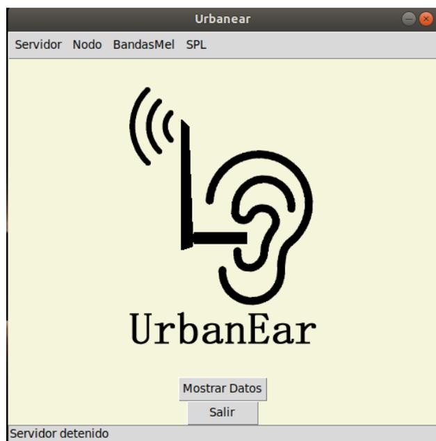
Figura 5.3: Interfaz gráfica de usuario. Las pestañas de la ventana permiten configurar los distintos parámetros del dispositivo, mientras que el botón central *Mostrar Datos* habilita la representación de datos adquiridos.
