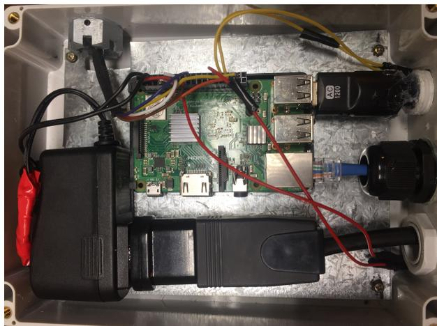
Figura A.4: Disposición de los componentes internos a la caja.
