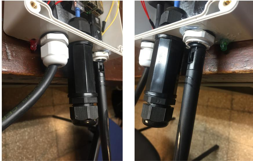
Figura A.5: Terminación de la cara inferior de la caja.
