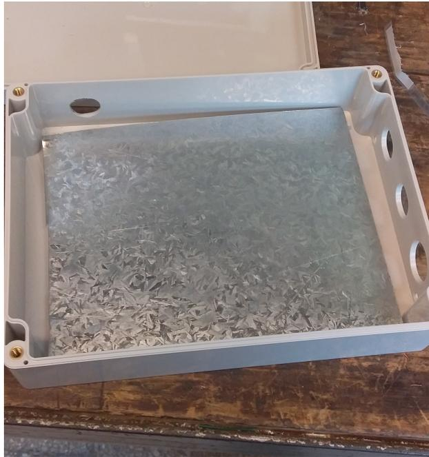
Figura A.3: Disposición de la lámina y los agujeros en la caja.
