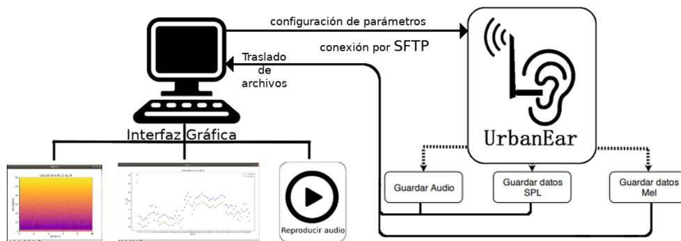
Figura 5.2: Interacción servidor-dispositivo. El dispositivo genera los archivos de interés que el servidor recupera por medio de una conexión SFTP. Los archivos se pueden visualizar/reproducir a través de una interfaz gráfica.
