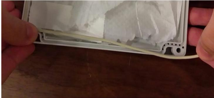
Figura A.7: Colocado de goma en la union de la caja.
