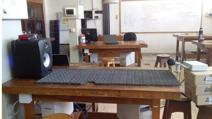
Figura 3.2: Montaje para calibración. Se utiliza un parlante con perfil plano y espuma acústica para minimizar el rebote en la mesa. Se coloca el micrófono en un soporte horizontal en el cual se coloca en dos instancias independientes el micrófono de referencia y el DUT.
