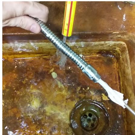
(b) Incidencia externa de agua sobre el *gooseneck*, con la varilla en su interior.
