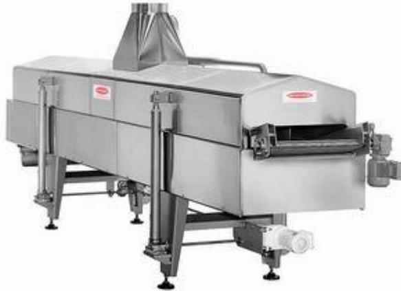
Después de retirado el exceso de agua, los bastones son encaminados a una freidor continuo que es alimentado de forma de mantener un período de fritura de 1,5 minutos constante en todo el flujo. La temperatura del aceite será de 180° C, no debiendo exceder ese límite para evitar su rápido deterioro. Deberá ser utilizado un aceite vegetal hidrogenado, normalmente de algodón o soja, para aumentar su estabilidad contra su rancidez.
