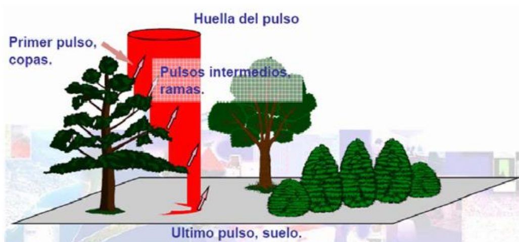
Imagen 2: Esquema de retorno de pulsos láser. Fuente: SAN JOSÉ ALBACETE, Antonio. 2011
