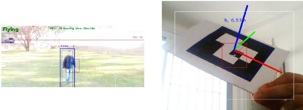
(a) Seguimiento de una detección      (b) Estimación de posición de marcador
