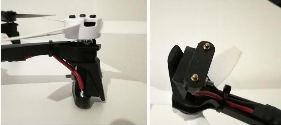
Figura 17: Contactos de carga en uno de los brazos del dron.
