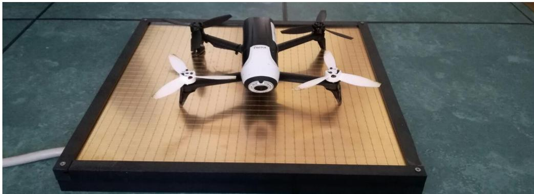
Figura 16: Bebop 2 cargando sobre la plataforma.
