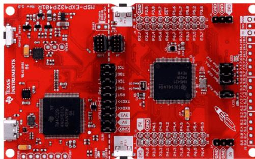
Figura 3.2: MSP432P401R Launchpad. Imagen extraída de [8]
