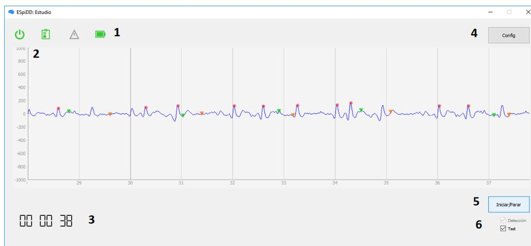
Figura 6.7: Pantalla del Estudio: 1- Estado del sistema, 2- Señal registrada en el canal de detección con marcadores, 3- Tiempo de Estudio transcurrido, 4- Botón del Wizard, 5- Botón para iniciar o parar el Estudio, 6- Casillas para habilitar o deshabilitar el test cognitivo o la detección
