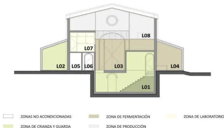
Figura 25 – Esquema de las zonas térmicas del edificio.
