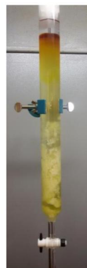
Figura 14. Columna en sílica gel de la amida.
