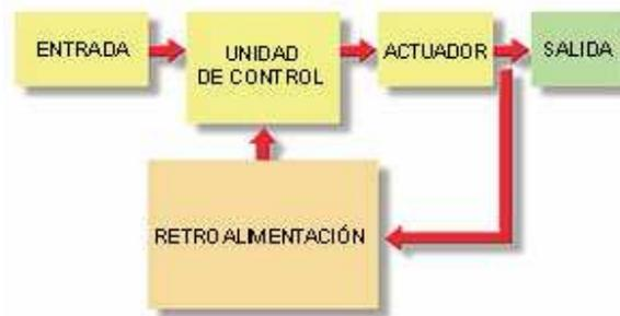
Figura 79 - Diagrama de bloques de un control PID
