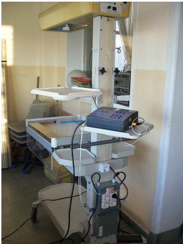
Figura 87 - Cuna radiante Air-Shields Vickers adaptada para ser controlada por CALORNAT 10
