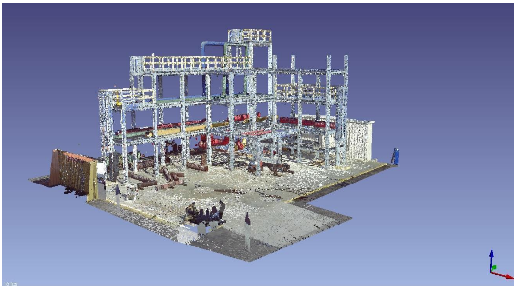
Figura 3.26: TLS aplicado a plantas industriales. (Fuente: Propia)
