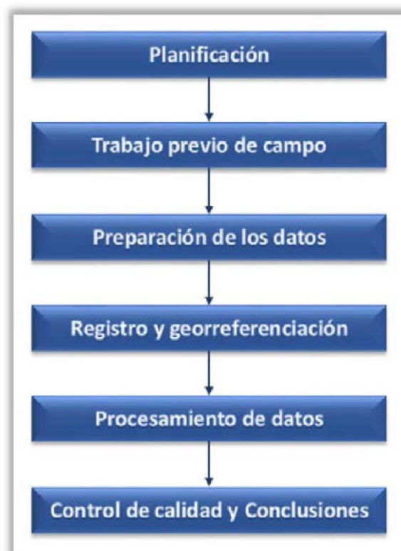
Figura 3.35: Método general de trabajo con equipos láser escáner. (Fuente: F. Romeral, 2014)
