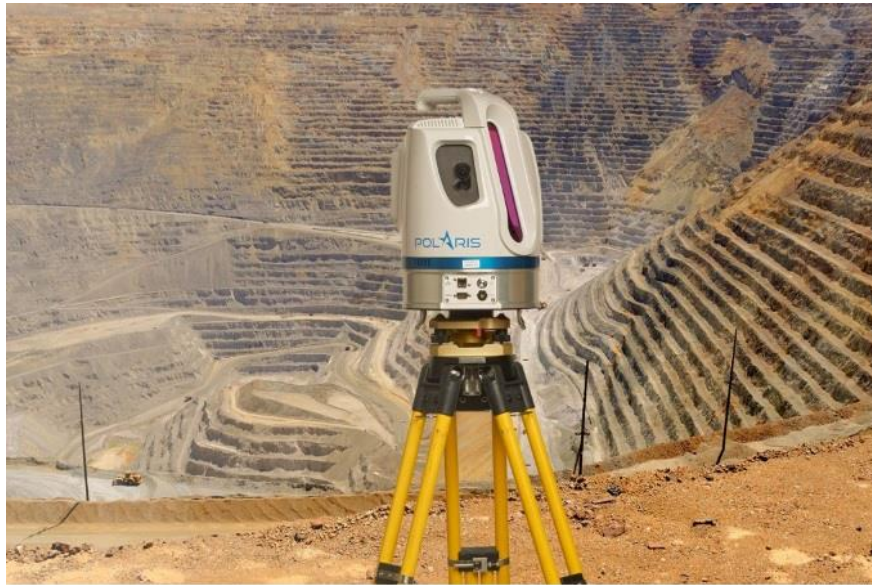
Figura 3.28: TLS aplicado al cálculo de volúmenes de canteras. (Fuente: https://grafinta.com/productos/polaris-laser-escaner-terrestre/ )
