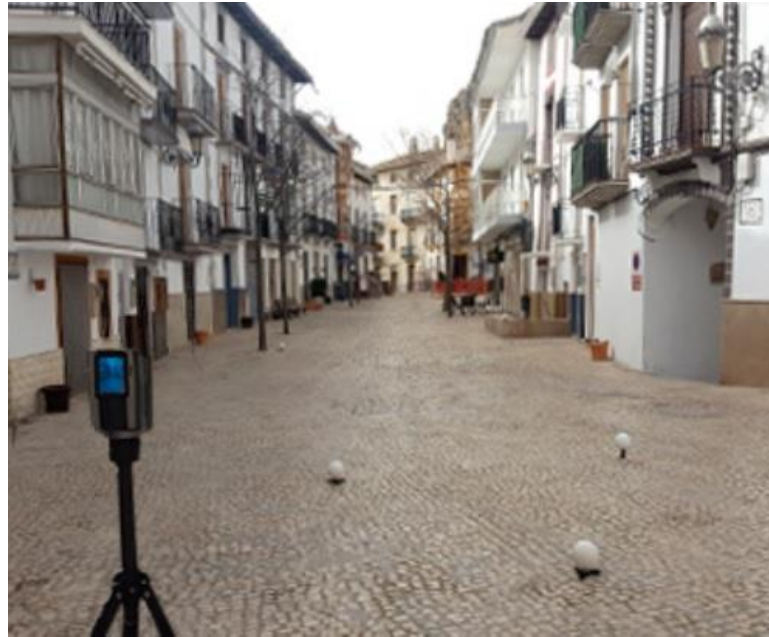
Figura 3.22: TLS aplicado a la topografía. (Fuente: https://www.bimnd.es/servicios/escaner-laser-3d/ )
