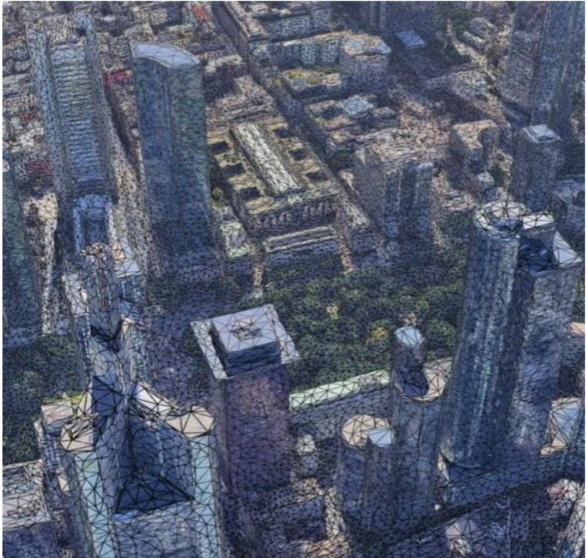
Figura B.1: Mapa en 3D del centro comercial de Frankfurt, Alemania, creado a partir de datos Lidar gratuitos y de código abierto e imágenes de satélite; Los edificios, el suelo y las calles consisten en una malla texturizada (fuente: Turbosquid.com).
