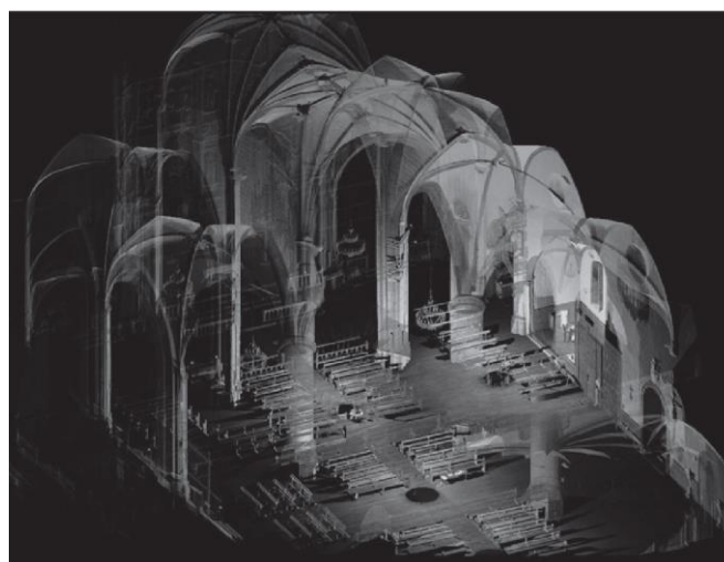
Figura 4.6: Modelo formado por la nube de puntos, resultado del relevamiento. (Fuente Garcia, Fernandez, Mesanza, 2011)
