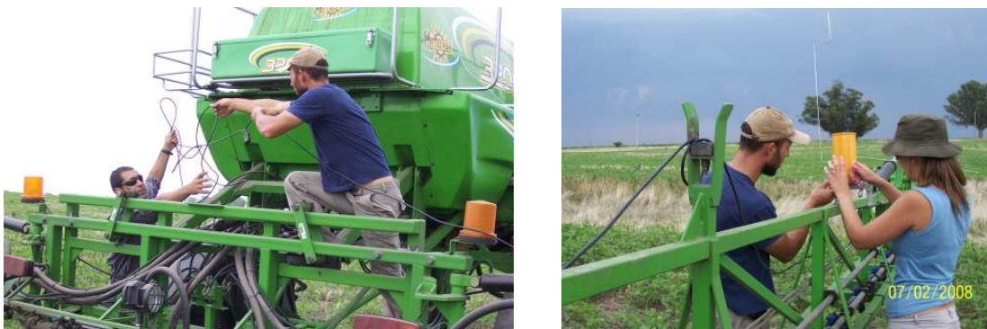
Figura No.3: Adaptación del dispositivo para la colocación en pulverizador autopropulsado
