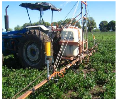
Figura No.2: Dispositivo de colecta de deriva en pulverizador autopropulsado y convencional.
