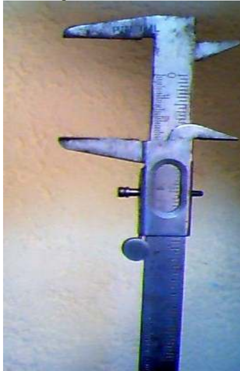
Figura No. 4: Calibre utilizado para la medición del diámetro a la altura del cuello
