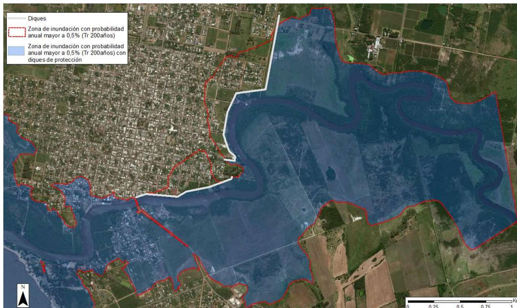
Figura 13-3. Envoltente de inundación para Tr 200 años considerando la presencia de los dos diques de protección.
