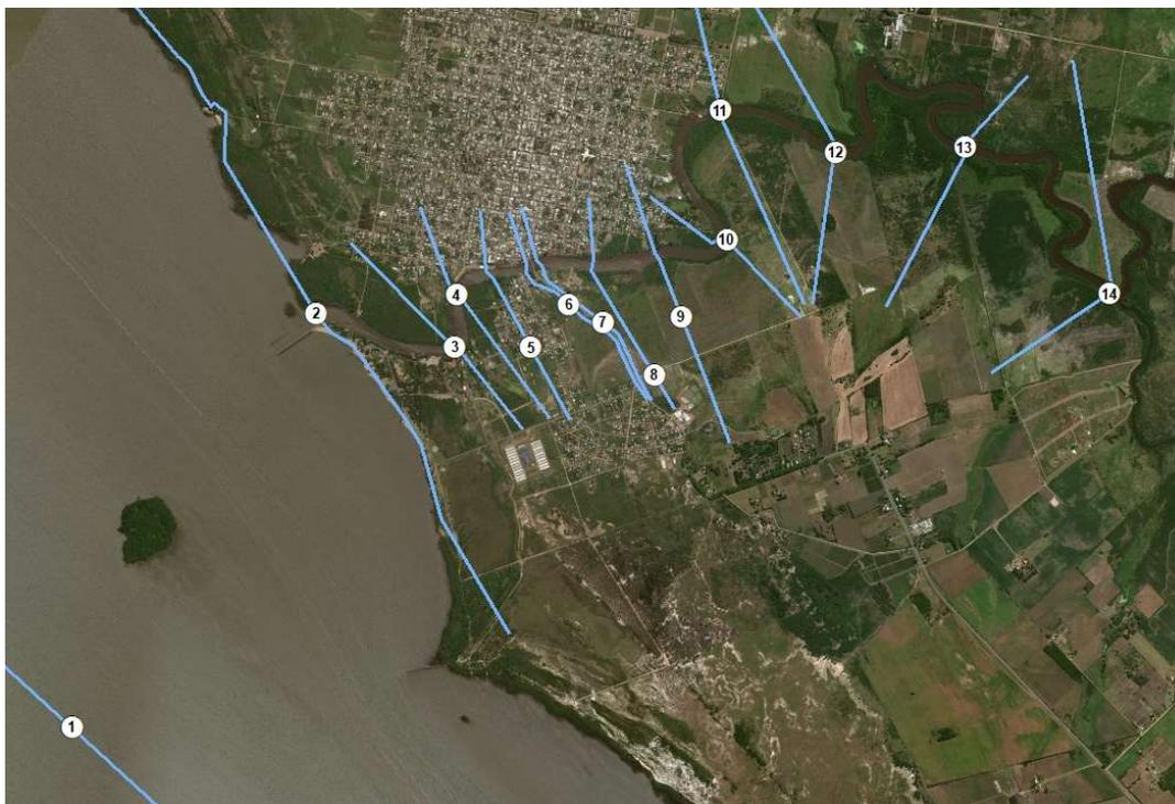
Figura 7-7. Secciones consideradas en el modelo hidrodinámico.
