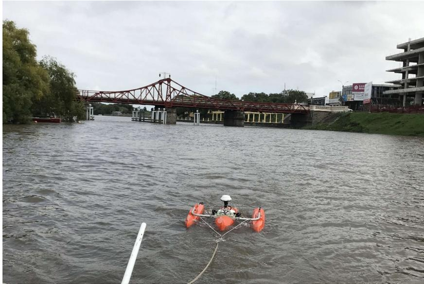
*Figura 17-4. Fotografía del ADCP en funcionamiento tomada el 24/04/2018 día en que se hizo la salida de campo en Carmelo.*
