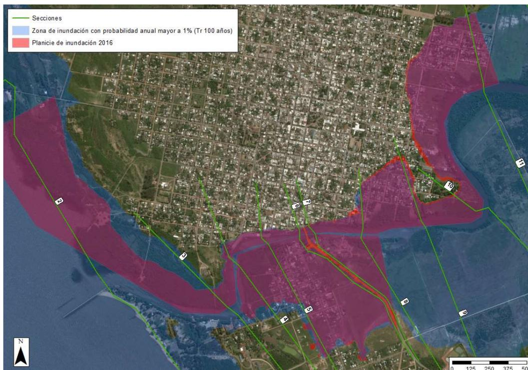
Figura 17-3. Superposición de envolvente de Tr 100 años y mancha de inundación relevada.
