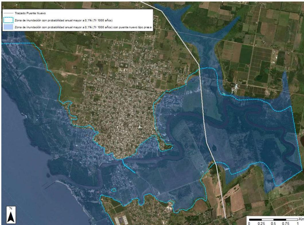
Figura 12-5. Comparación de las planicies de inundación con y sin puente tipo presa para la envolvente de Tr 1000 años.
