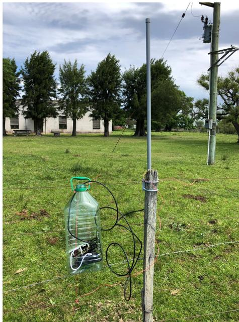
Figura 14: Gateway colocado en un alambrado a nivel del piso.
