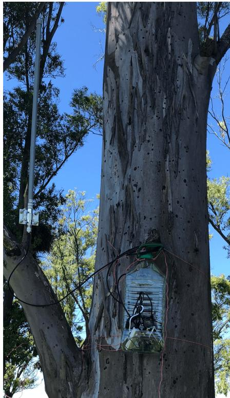
Figura 15: Gateway colocado en un árbol con altura aproximada de 3 o 4 metros.
