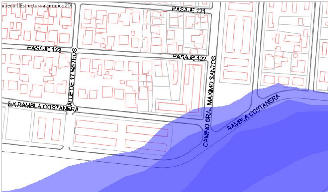
Figura 3.1 - Superficie inundada para cotas actuales montada sobre planta de vialidad proyectada (zona de inundación de asentamiento Costanera).
