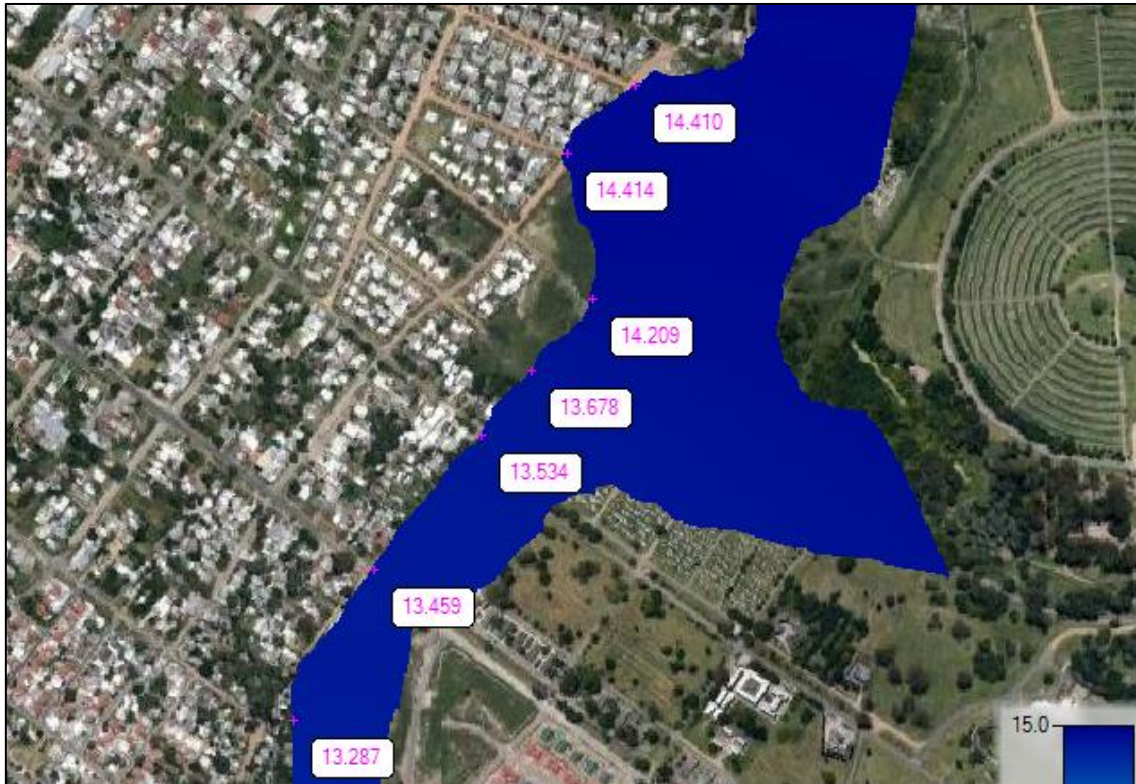
Figura 3.4 - Superficie inundada obtenida con RAS Mapper, cotas indicadas referidas al cero Wharton.
