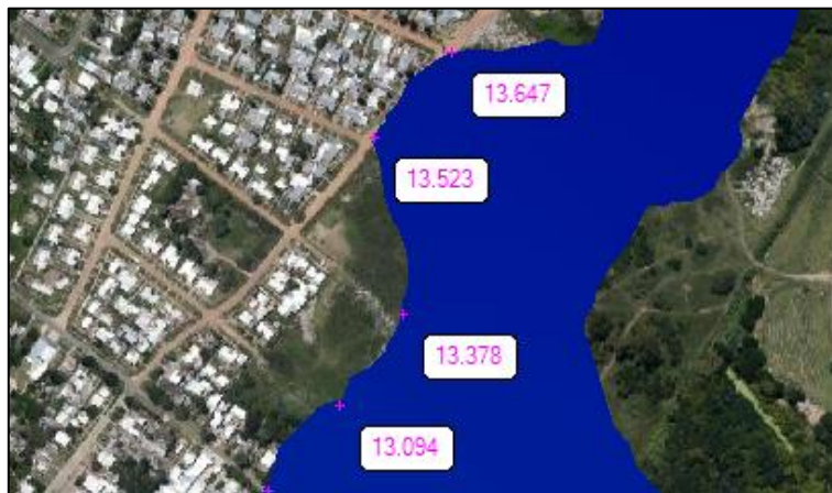
Figura 3.13 - Cotas de superficie de agua para crecida de 100 años de período de retorno y secciones canalizadas.
