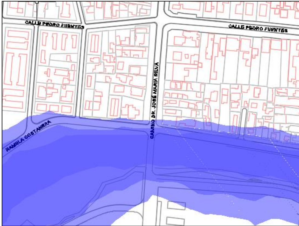
Figura 3.2 - Superficie inundada para cotas actuales montada sobre vialidad proyectada (zona de inundación en nuevas viviendas sobre la calle Rambla Costanera).
