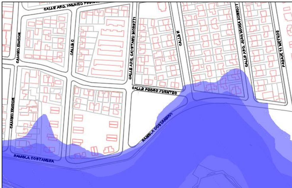
Figura 3.3 - Superficie inundada para cotas actuales montada sobre vialidad proyectada (zona de inundación en viviendas desde Calle E hasta Juan María Aubriot).
