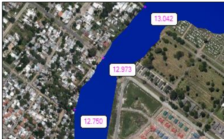
Figura 3.12 - Cotas de superficie de agua para crecida de 100 años de período de retorno y secciones canalizadas.
