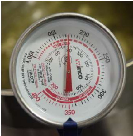
PASO #12. Controlar que la temperatura no exceda los 80°C.
