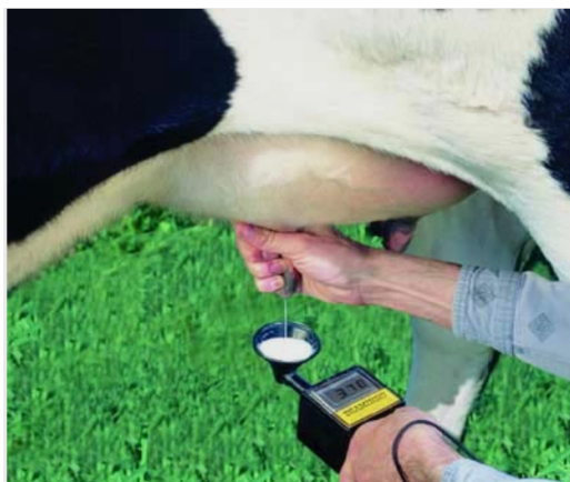
Figura 1.1: Dispositivo para determinación de la conductividad eléctrica de la leche. Imagen extraída de [6]
