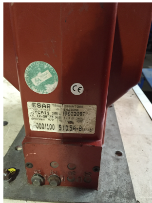
Figura 3.29: Transformador de relación 100V/6000V utilizado para el ensayo del divisor en Mantenimiento Especializado SRL.
