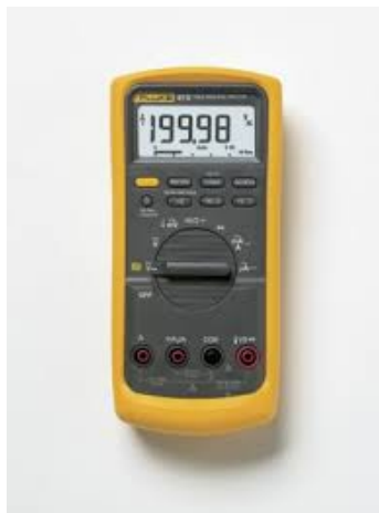
Figura 3.32: Multimedidor Fluke 87 V de verdadero valor eficaz utilizado para el ensayo del divisor en Urutransfor SA.
