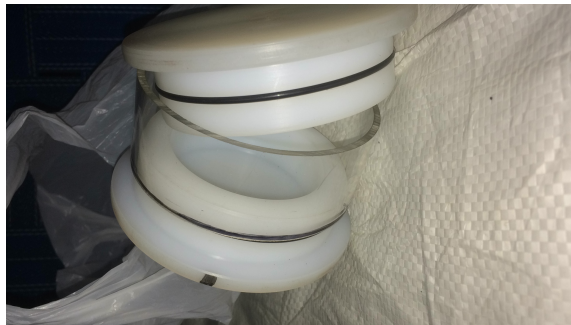
Figura 3.8: Tapas del divisor construidas en nylon con o-ring de goma sintética para evitar fugas de aceite.
