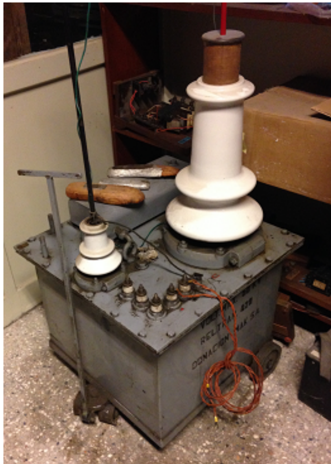
Figura 2.7: Transformador de Ensayo a utilizar
