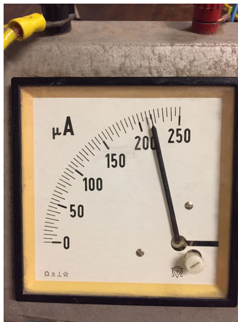
Figura 3.4: Lectura del amperímetro con 200V aplicados en bornes del amperímetro.
