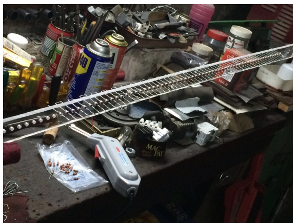
Figura 3.9: Listón de acrílico que oficia de soporte a las resistencias que conforman el divisor.
