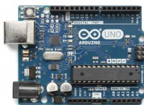
Figura 4.19: Arduino UNO. Tomada de la página de Arduino [75]
