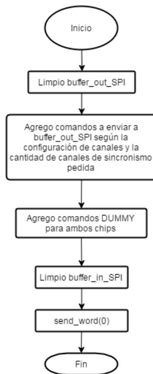
Figura G.4: Diagrama de flujo de la función CONVERTburst().
