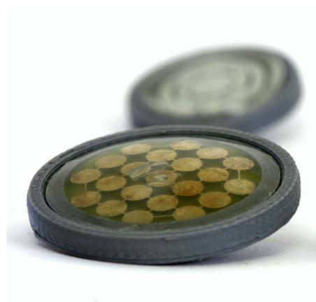
(b) Electrodo de contacto sin cabello (DRYPAD SENSORS).
