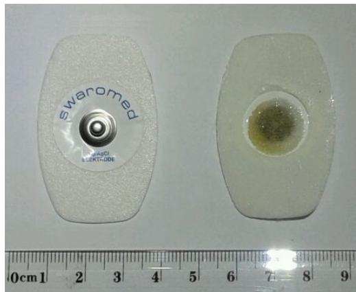
Figura 7.1: Electrodo húmedo de cloruro de plata (Ag/AgCl).
