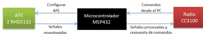
Figura 4.1: Tipo de datos que comparte el microcontrolador con el resto de los bloques del módulo remoto.
