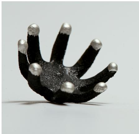
(a) Electrodo de contacto con el cuero cabelludo (FLEX SENSORS).
