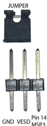
Figura D.1: Jumper para tener disponible la función de activación de electrodos. En esta versión del sistema no se va a realizar la activación de electrodos, por lo tanto este jumper va siempre conectado donde indica la figura. Si se desea implementar la activación de electrodos, el valor de VESD se impone con el microcontrolador a través del pin 14 del conector MSP3.
