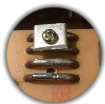
(a) Chapas de condensadores.
