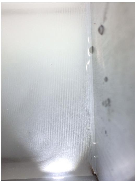
Figura 2.20: Visualización de nodos de presión a frecuencia de máximo consumo de potencia vista superior
