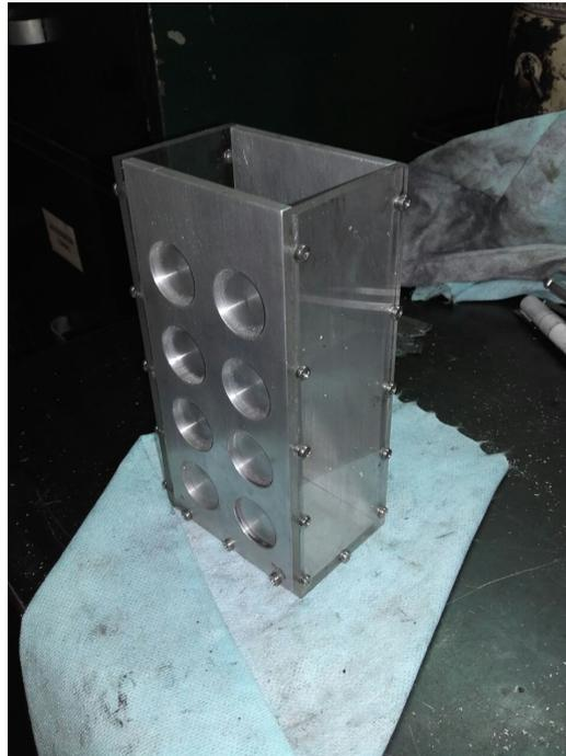
Figura 2.5: Cubeta fabricada, sin cerámicas pegadas.
