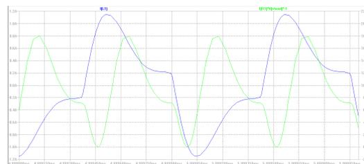
Figura 4.25: Corriente por el inductor y potencia disipada en la resistencia.
