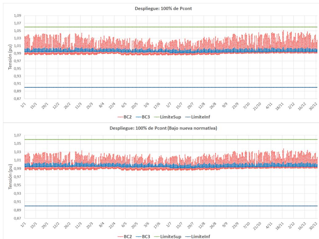
Figura 5.19: Perfil de tensión de las barras BC2 y BC3 para un despliegue del 100 % en microgeneración.
