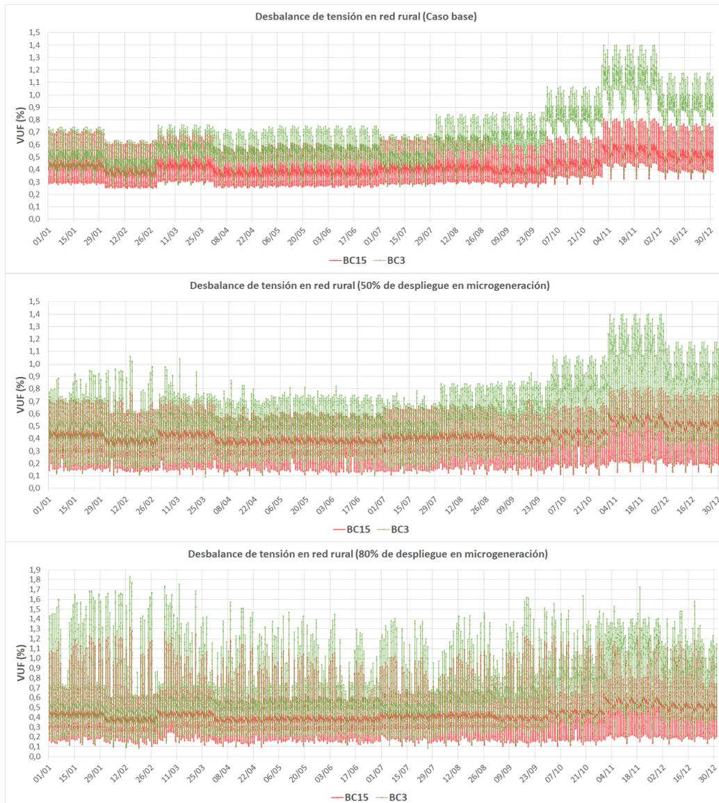
Figura 5.36: Comportamiento de las curvas de desbalance para la red rural.
