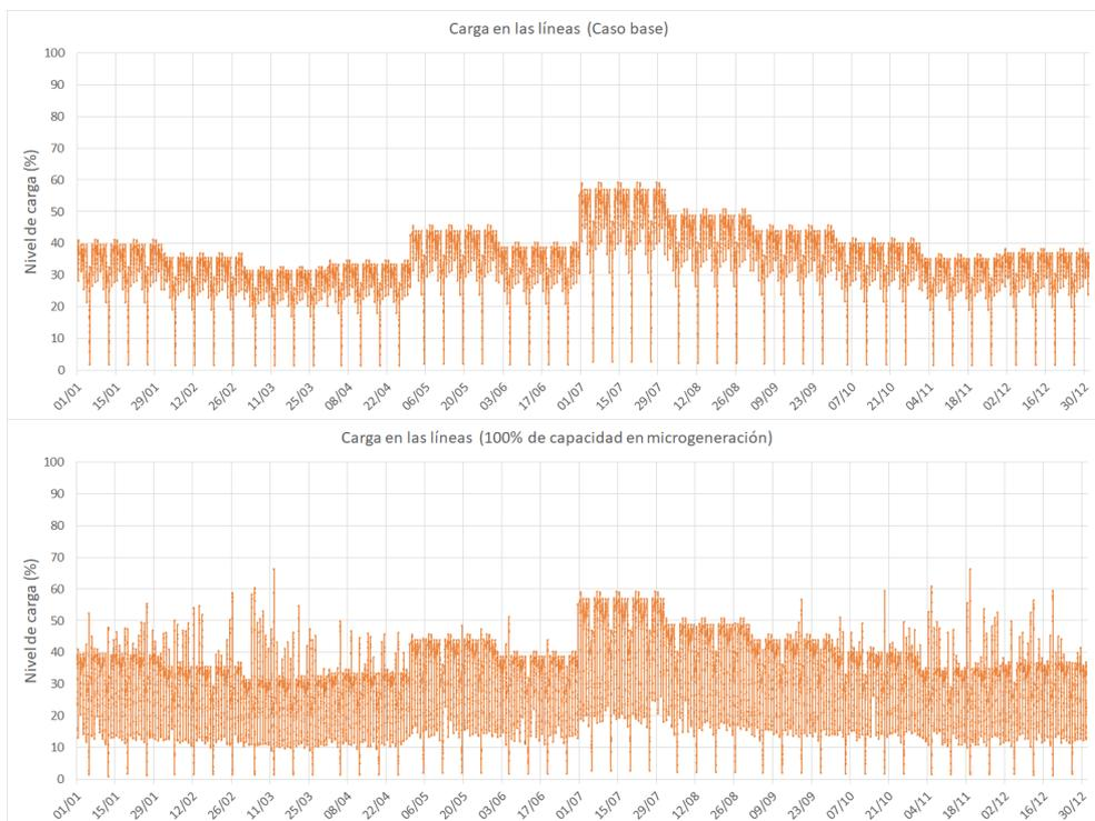
Figura 5.34: Resultados para la línea con mayor carga de la red industrial en el período de un año.
