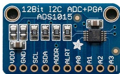
Figura 2.12: Conversor analógico digital ADS1015.
