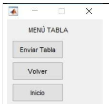
Al enviar la Tabla verifique que es correctamente recibida por el equipo SECon LAI. Para verificar esto, identifique en la esquina superior derecha de la pantalla aparece una letra “T” indicando que el sistema posee una tabla cargada.
