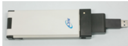
Figura 5.16: Prototipo de USB-stick IEEE 802.11af [37].
