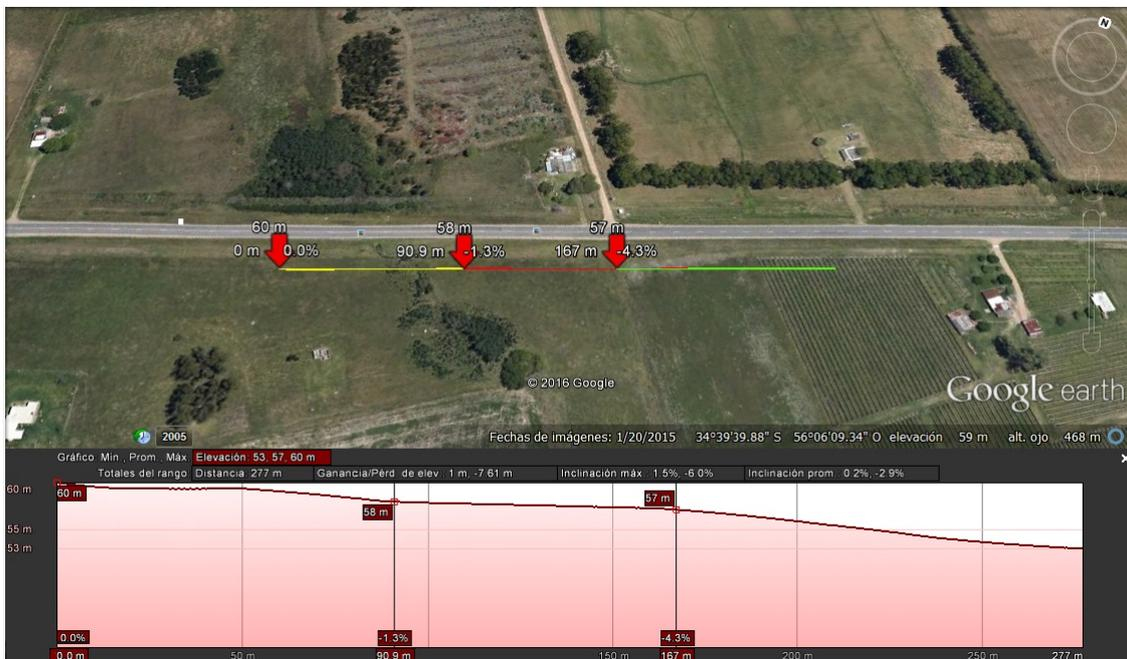
Figura 4.19: Perfil de elevación del suelo
