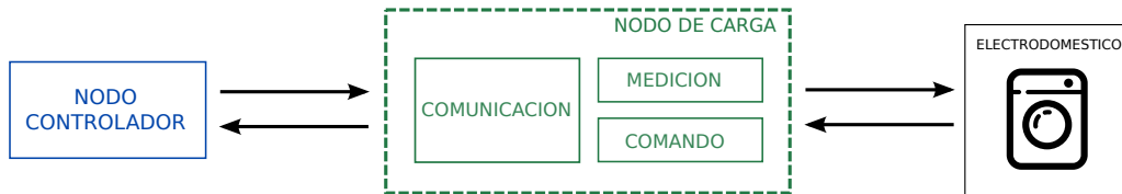
Figura 3.4: Módulos de un Nodo de Carga
