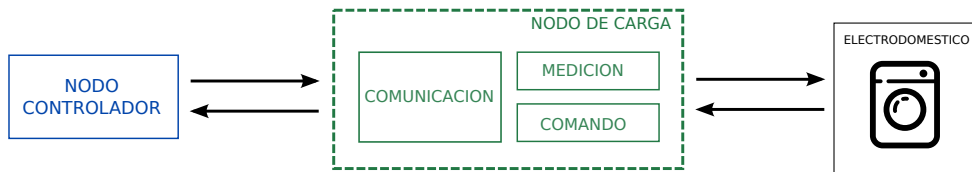
Figura L.1: Módulos de un Nodo de Carga
