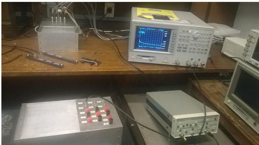
Figura F.5: Configuración de test de ruido.
