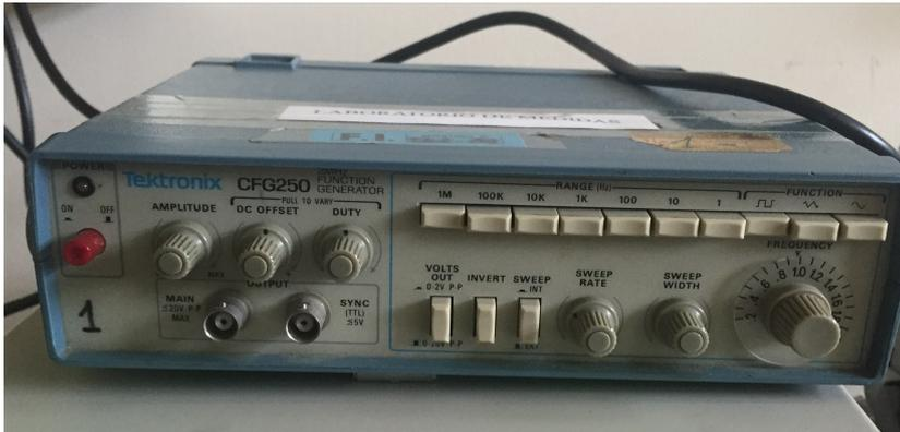
Figura D.2: Generador de señales Tektronix CFG250.
