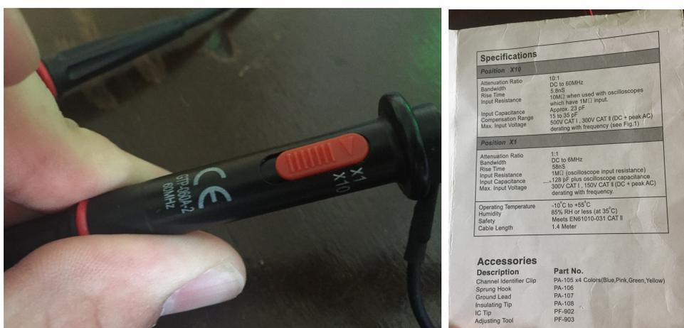
Figura D.6: Puntas de prueba utilizadas junto a su hoja de datos.
