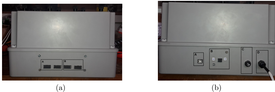
Figura D.2: D.2a Vista lateral derecha del equipo, se observan los puertos correspondientes a la comunicación con el sensor de temperatura(A) y los encoder para relevar la velocidad de las máquinas (B). D.2b Vista lateral izquierda, se observa el puerto USB (A) y el RS485 (B) correspondientes a la comunicación con la PC y el CVMk2 respectivamente. También se encuentra la entrada de alimentación de equipo (D) junto con el fusible de protección(C)
