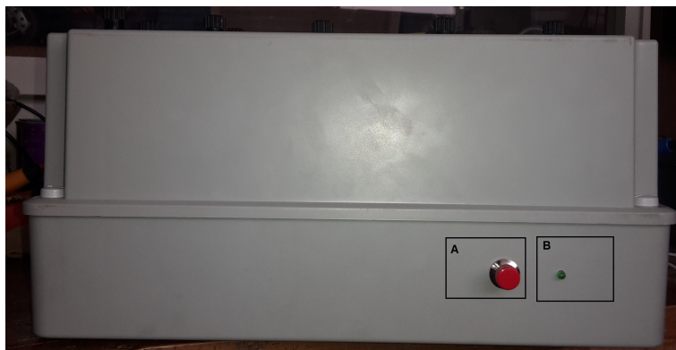
Figura 3.25: Vista lateral superior del equipo: A)Pulsador de encendido del equipo, B)Led indicador de estado del Equipo(ON/OFF)
