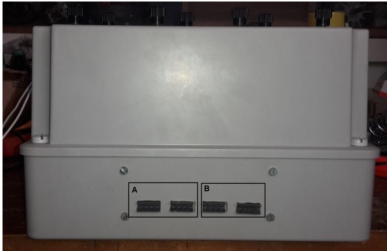
Figura 3.24: Vista lateral derecha del equipo: A)Puertos de adquisición de señales de Temperatura, B)Puertos de adquisición de señales de Velocidades
