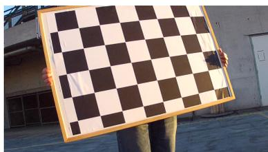
Figura 6.8: Objeto de calibración utilizado en el *amcctoolbox*
