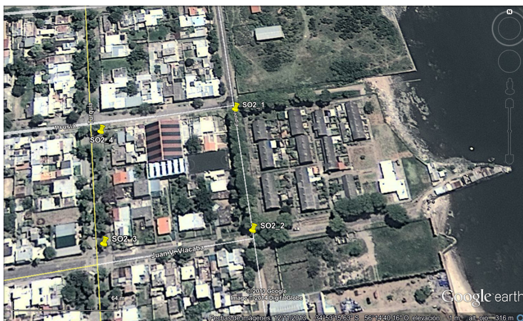
Figura 5.7: Puntos medidos para la locación SO2. Las 2 columnas de árboles obstruyen la línea de vista con la antena transmisora.
