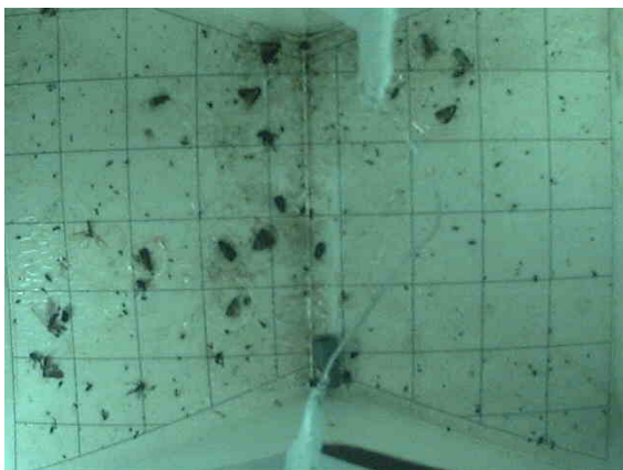
Figura 6.14: Iluminación con dos LEDs blancos dispuestos en esquinas cruzadas
