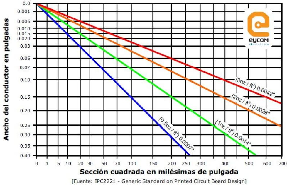
Figura F-2: Curva de ancho de pista en función de su sección del estándar IPC-2221.
