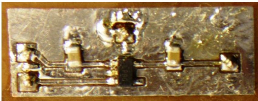
Figura 87. Circuito impreso fabricado para la implementación básica del LP2981
