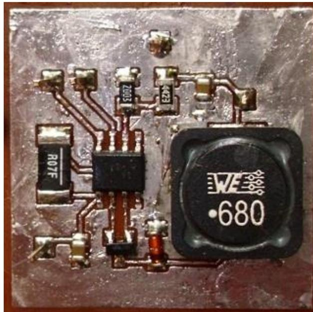
Figura 137. Circuito fabricado con implementación típica del MAX1627 brindada por el fabricante.
