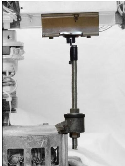
*Figura 62 - Montaje del Sensor de posición*
