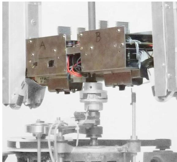
Figura 50 - Perfil de protección del módulo de alimentación y de las DE0-Nano
