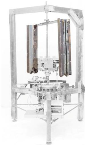
*Figura 58 - Perfiles para la protección de los elementos sobre el brazo*
