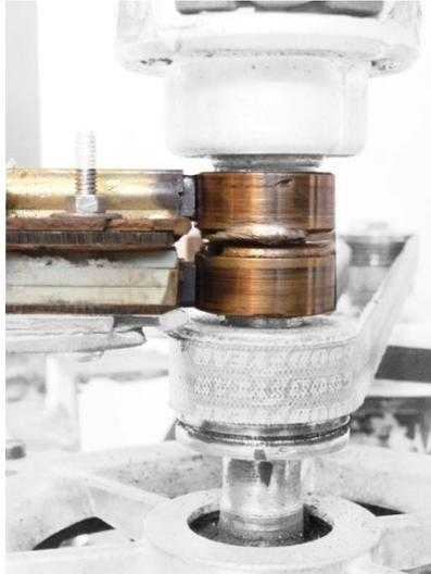
Figura 29 - Detalle de la Alimentación de los carbones
