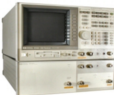
Figura 109 – Analizador de espectros utilizado (HP 8546 A)
