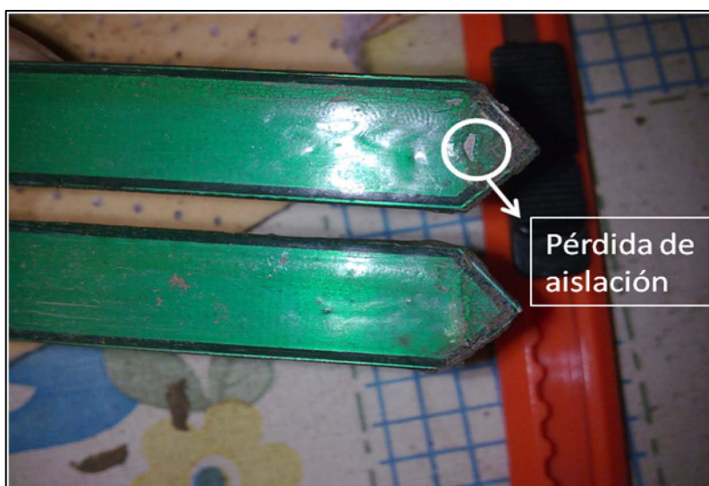
Figura 80 - Detalle de puntas desgastadas
