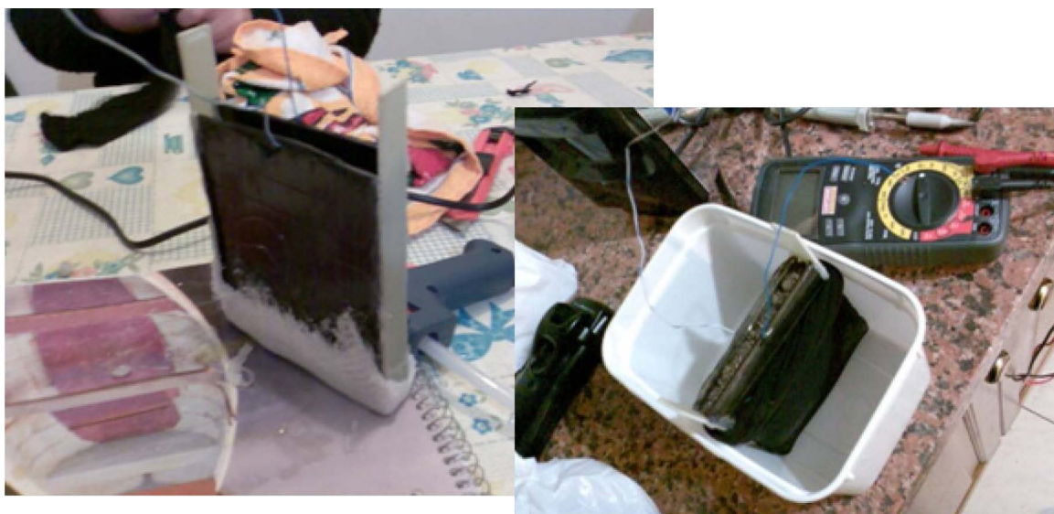
Figura 108 – 4to intento - Placas aisladas y volumen controlado de tierra
