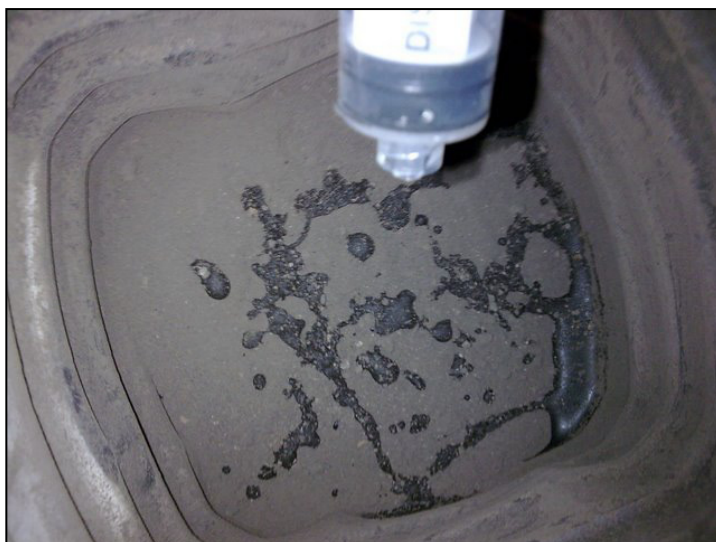
Figura 58 - Agregando el agua a cuentagotas a la tierra seca 31
