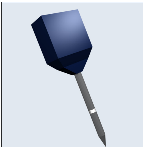
Figura 48 – Ejemplo de sensor basado en medida alrededor de la pequeña aislación (zona blanca)
