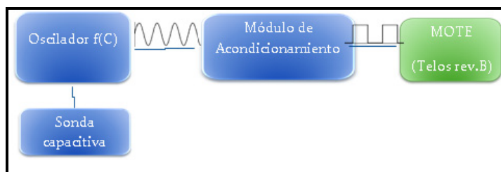
Figura 18 - Diagrama general del sensor
