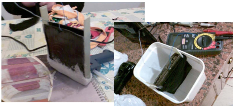
Figura 8 - Placas aisladas y volumen controlado de tierra
