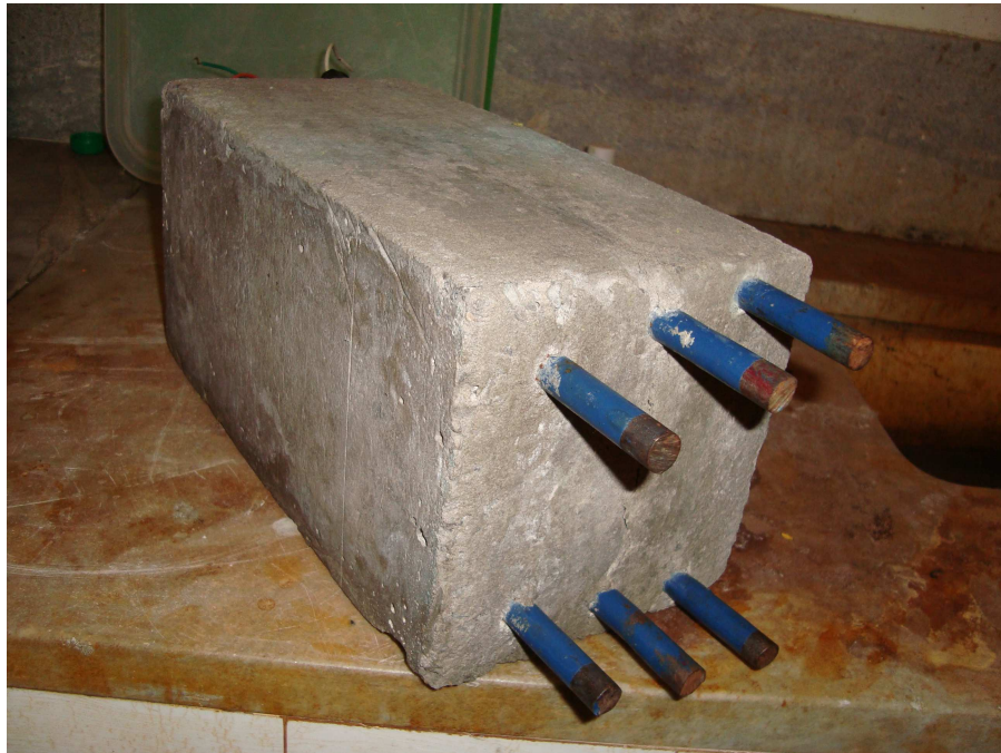
Figura 7.16: Foto de probeta poco corroída (preparada normalmente).
