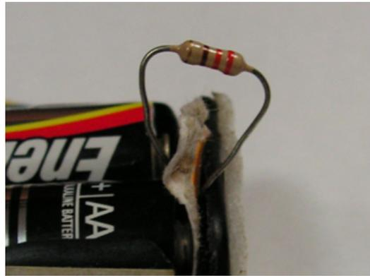
Figura 6.1: Imagen ilustrativa de conexión de resistencia para medir el consumo del mote
