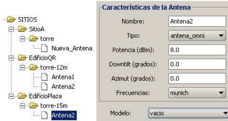
Figura 7.2: Ubicación de una antena en el contexto de una red y parámetros que la definen
