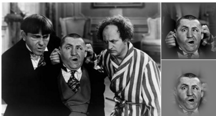
Figura 4.12: A la izquierda la imagen original. En el borde superior derecho se observa la imagen normalizada sin utilizar máscara. En el borde inferior derecho se aprecia el efecto de la máscara elíptica.
