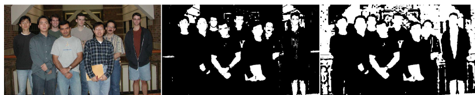
Figura 4.1: Ejemplos de los resultados obtenidos en la segmentación utilizando distintos clusters . En primer lugar se observa la imagen original, luego los resultados para el cluster RGB y finalmente los correspondientes al cluster YCbCr.
