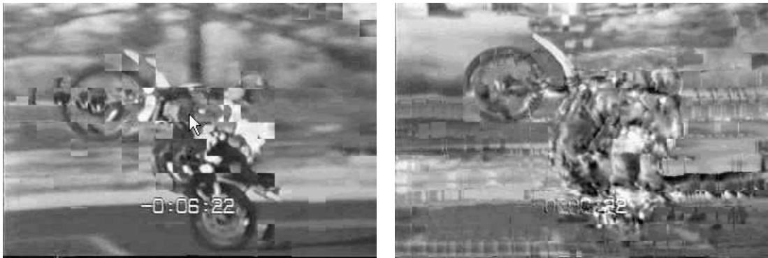
Figura 2.2: Efectos de la codificación (izquierda - MPEG-1, derecha - MPEG-4)
