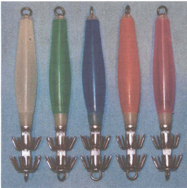
Figura 2. Potera utilizada en la pesca del calamar (Dragonetti, 2012)
