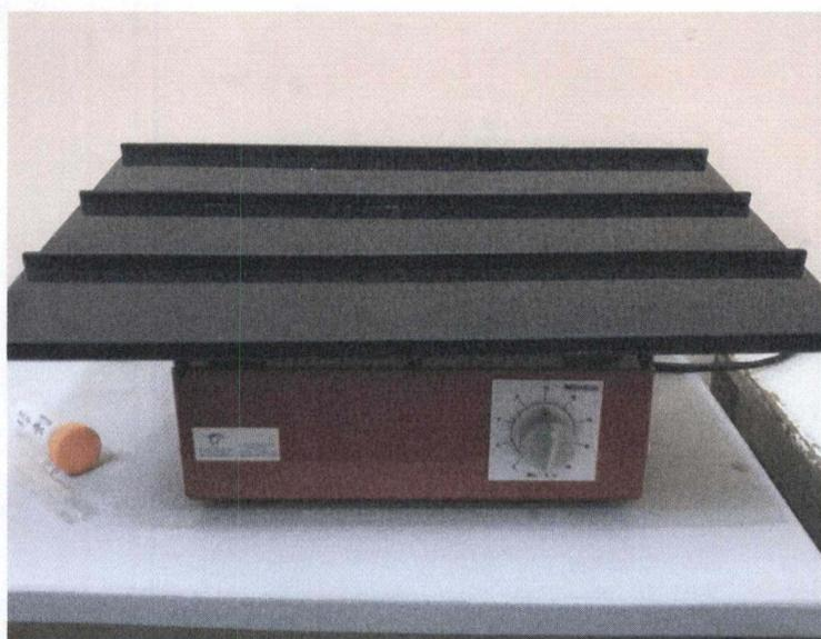
**Figura 1.** Rotador utilizado en la prueba de aglutinación RB. Daniela Rosas.
