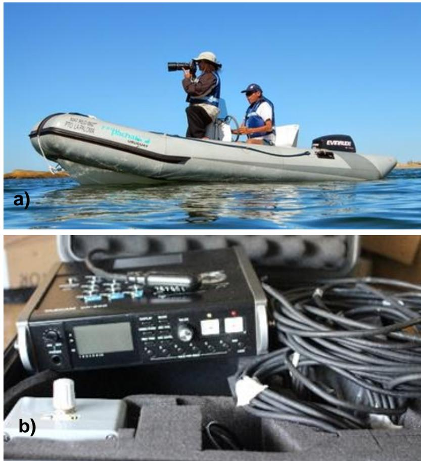
Figura 8. a) Gomón semirrígido de Asociación Civil Yaqu Pacha Uruguay; b) Hidrófono HTI-96-MIN y grabador digital TASCAM DR-680 utilizados para los registros acústicos.
