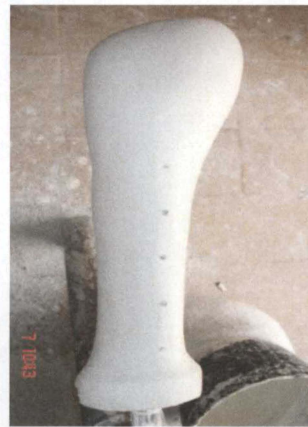
Fig. 46: molde positivo del miembro, pronto para comenzar a realizar la prótesis sobre él.
