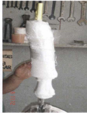
Fig. 48: Encastre realizado con mallas y fibra de vidrio.
