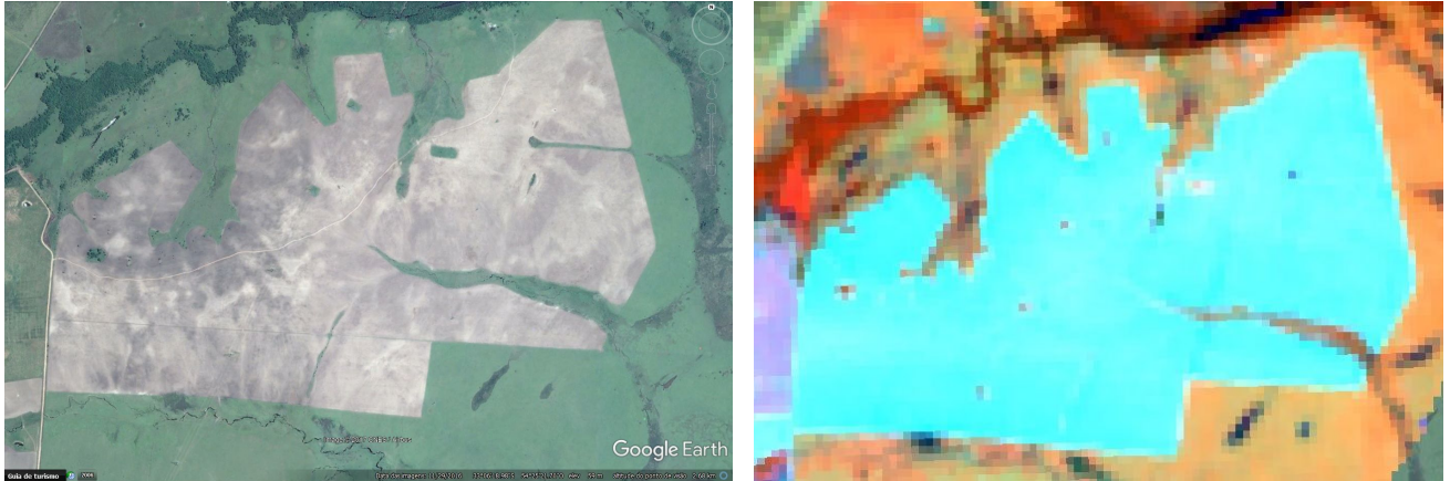
Figura 15. Parcela de suelo desnudo con marcados límites y de color tierra (imagen izquierda). En falso color es representada por un fuerte tono celeste, lo que facilita su identificación (imagen derecha).
